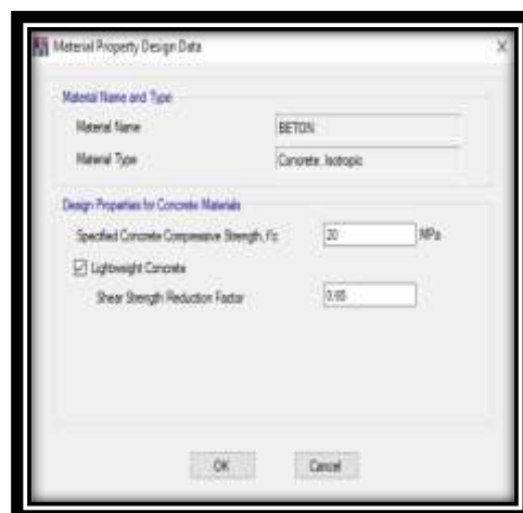
Gambar 3 Material Struktur Beton 20,75 MPa SNI 2013
