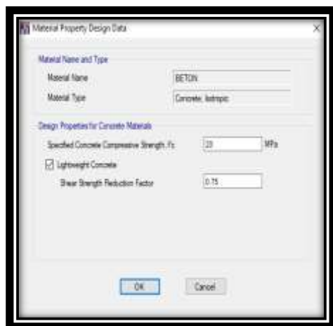
Gambar 2 Material Struktur Beton 20,75 MPa SNI 2002
